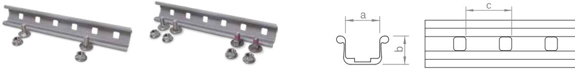
Verbinder C-Schiene 38, mit zwei Flachrundschrauben und Sperrzahnmuttern mit Sechskantantrieb SW 18, wahlweise als Loslagerausführung mit vier Flachrundschrauben.
