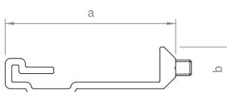
Verbinder Einlegeschiene für gerahmte Module, l = 150 mm, wahlweise blank oder schwarz (sw) eloxiert erhältlich.
