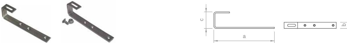
Dachhaken für die Montage von C-N-Schienen bzw. C-Schienen als Fall- und Querschienen auf Dächern mit Schiefer- oder Schindeleindeckung, Anschluss Schiene-Dachhaken mit L-Adapter im Langloch 11x41mm bzw. im Set mit Flachrundschraube M10, für Anschluss C-Schiene.
