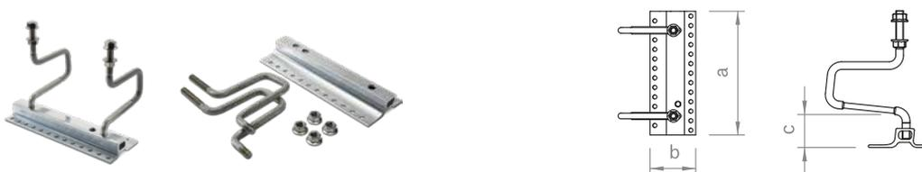
Dachhaken für die Montage von C-Schienen als Querschienen auf Dächern mit Biberschwanzziegeln, optimiert für hohe Lasten, Anschluss Schiene-Dachhaken höhenverstellbar bis 35 mm, Anschluss Dachhaken-Grundprofil höhenverstellbar für 24–30 mm Dachlattung, für Biberschwanz-Doppeldeckung.
