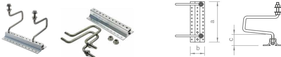
Dachhaken für die Montage von C-Schienen als Querschienen, optimiert für schmale Sparren und hohe Lasten, Anschluss Schiene-Dachhaken höhenverstellbar bis 30 mm, Anschluss Dachhaken-Grundprofil höhenverstellbar für 24–30 mm bzw. 31–40 mm Dachlattung, für Ziegelüberdeckungen bis ca. 95 mm, je nach Ziegeltyp.
