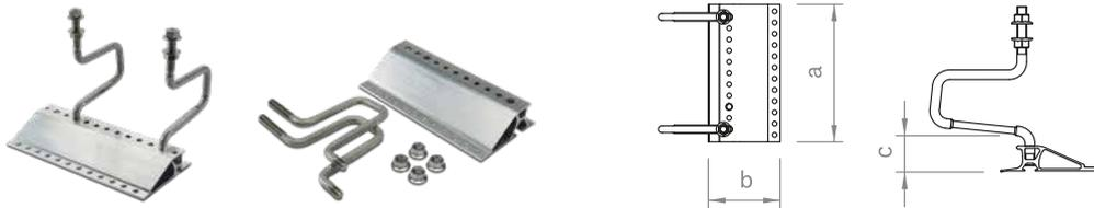
Dachhaken für die Montage von C-Schienen als Querschienen, optimiert für hohe Lasten, Anschluss Schiene-Dachhaken höhenverstellbar bis 35 mm, Anschluss Dachhaken-Grundprofil höhenverstellbar für 24–30 mm bzw. 31–40 mm Dachlattung, für Ziegelüberdeckungen bis ca. 95 mm, je nach Ziegeltyp.
