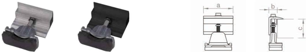
Endklemme zur Befestigung der Module auf der C-Schiene oder C-N-Schiene, montagefreundlich dank Arretierfunktion. Antrieb Klemmschraube Aussensechskant SW 8. Für Rahmenhöhen von 30 – 42 mm bzw. 43 – 52 mm, wahlweise blank oder schwarz (sw) eloxiert erhältlich.
