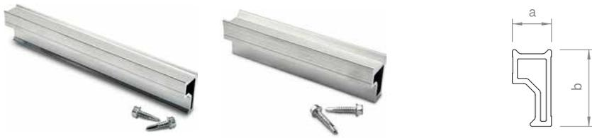
Verbinder C-N-Schiene 37, Verschraubung mit zwei Dünnschrauben mit Sechskantantrieb SW 8.
