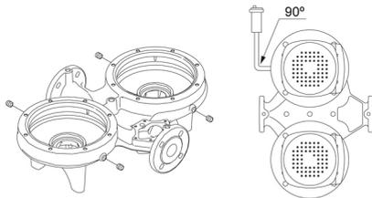
Die Flansche haben Gewindebohrungen für die Montage von Manometern.
