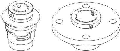
Die Gleitringdichtung wird durch eine Abdeckung und mit Hilfe von vier Schrauben im Kopfstück gehalten. Sie kann ausgetauscht werden, ohne dass der Motor abgebaut werden muss.
