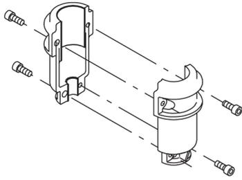
Das Kopfstück verbindet den Pumpenkopf mit dem Motor. Der Pumpenkopf besitzt einen kombinierten Einfüll- und Entlüftungstopfen (1/2 Zoll).
