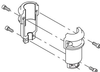
Das Kopfstück und der Flansch für die Motormontage sind ein Bauteil, das aus Grauguss gefertigt wird. Die Abdeckung des Pumpenkopfs ist ein getrenntes Bauteil aus Edelstahl. Das Kopfstück besitzt einen kombinierten Einfüll- und Entlüftungsstopfen (1/2").
