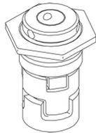
Die Gleitringdichtung wird in das Kopfstück geschraubt.
