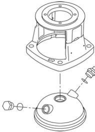
Der Drucksensor ist an der Pumpe montiert.
