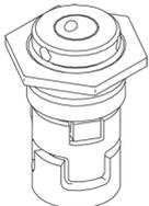
Die Gleitringdichtung wird in das Kopfstück geschraubt.
