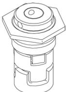
Die Gleitringdichtung wird in das Kopfstück geschraubt.
