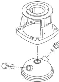
Der Drucksensor ist an der Pumpe montiert.
