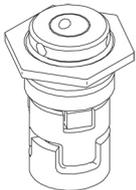
Die Gleitringdichtung wird in das Kopfstück geschraubt.
