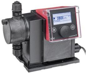
SMART Digital Membrandosierpumpe mit Schrittmotorantrieb für pulsationsarme und kontinuierliche Dosierung. Dank Dreh-/Drückrad und informativem Display ein Optimum an Bedienkomfort.
