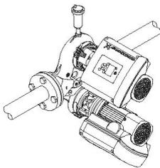
Die Motorlaterne verbindet das Pumpengehäuse mit dem Motor und ist mit einer manuellen Entlüftungsschraube ausgerüstet, über die das Pumpengehäuse und die Dichtungskammer entlüftet werden können. Zur Abdichtung der Motorlaterne gegenüber dem Pumpengehäuse wird ein O-Ring verwendet.
