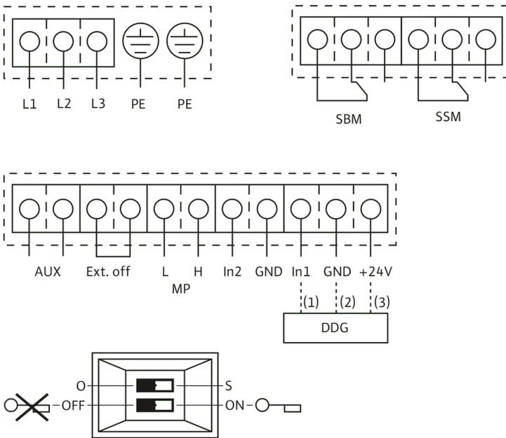
L1, L2, L3: Netzanschluss: 3~440 V  $\pm$ 10 %, 50/60 Hz; 3~400 V  $\pm$ 10 %, 50/60 Hz; 3~380 V -5 %/+10 %, 50/60 Hz
