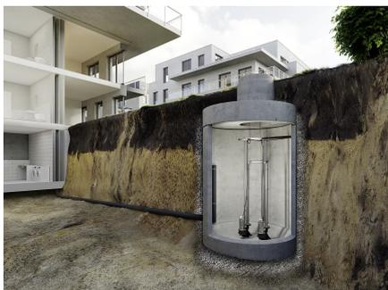
Die Pumpen sind im Fördermedium eingetaucht. Der Anschluss an die Druckleitung erfolgt normalerweise über eine Einhängevorrichtung. Zu Wartungszwecken können die Pumpen von oben aus dem Schacht herausgenommen werden. Hierfür müssen keine Schrauben gelöst oder das Wasser abgelassen werden.
