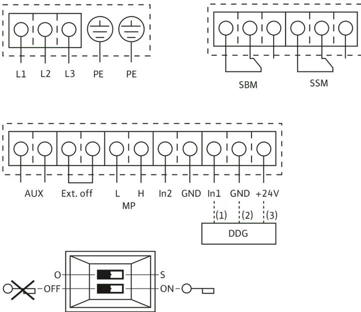
L1, L2, L3: Netzanschluss: 3~380 V - 3~480 V ( $\pm$ ;10 %), 50/60 Hz
